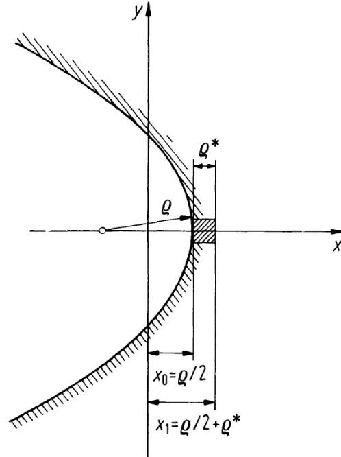
Bild 4.8. Zur Definition der Mikrostützwirkung
